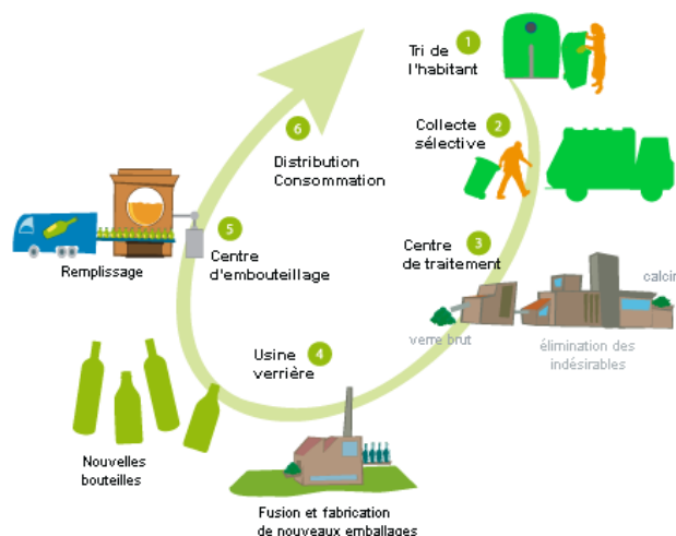
Schéma du recyclage des emballages en verre
