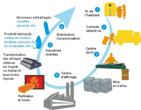
Schéma du recyclage des emballages en aluminium
